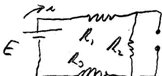
$$i = \frac{E}{R_1 + R_2 + R_3} = 0.17A$$
